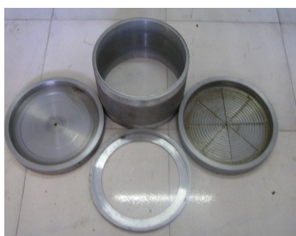
图 2 自制压力室主要部件示意图
